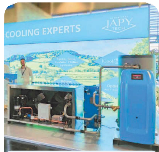
Intercambiador de calor de placas asociado con un enfriador modular (EuroTier 2022)
