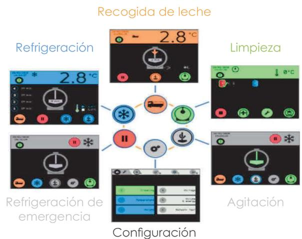
El terminal ICool está diseñado para controlar todas las funciones de un refrigerador de leche :
