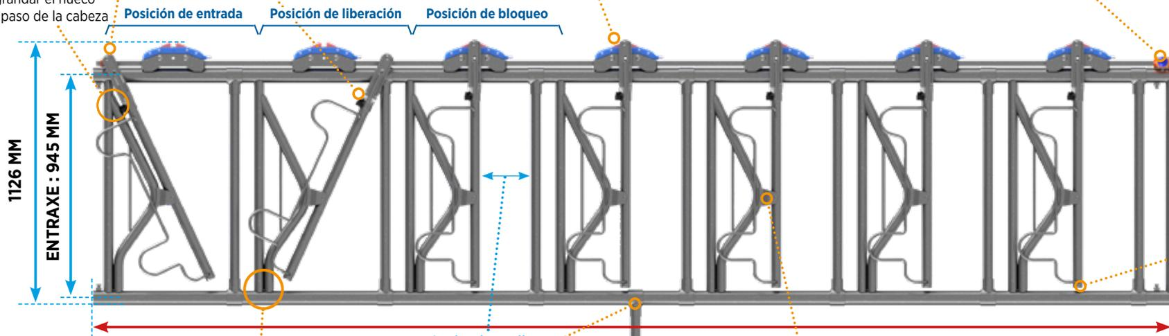
La parte baja del balancín es de forma cónica para evitar el enganche de los collares.
