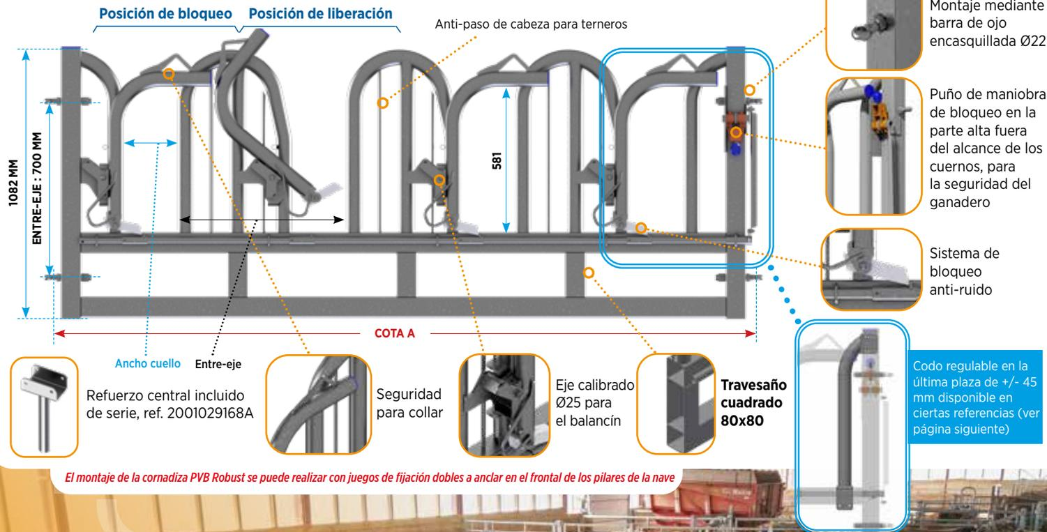
El montaje de la cornadiza PVB Robust se puede realizar con juegos de fijación dobles a anclar en el frontal de los pilares de la nave
