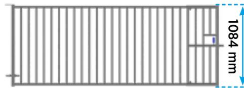
Longitud regulable en 70mm para adaptar a la instalación
